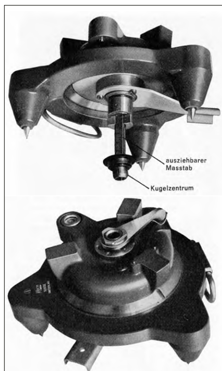
Abb. 5: Kern Pfeilergrundplatte (Kobold 1958).
