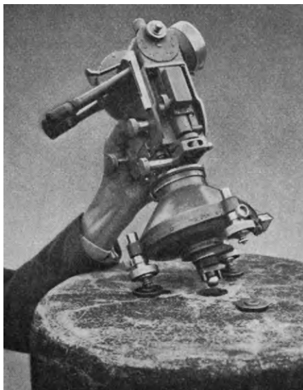
Abb. 4: Wild T3 mit Kugelzentrierung (Untersee 1951).
