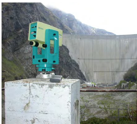
Abb. 8: Kern Mekometer ME5000 (1994) vor der Staumauer «Mauvoisin» (© Pöyry Schweiz AG).
