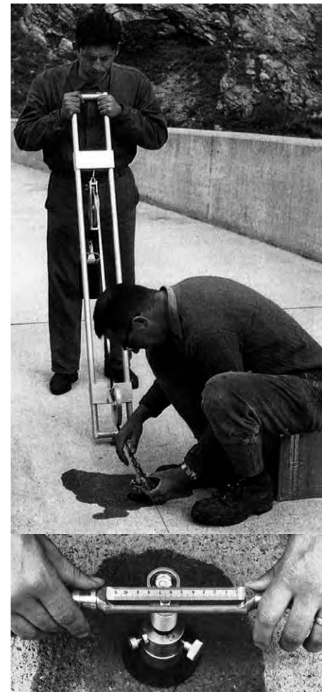
Abb. 6: Distanzmessung mit Invarband/-draht; Spannbock und Ablesemasstab für Polygonmessung auf der Staumauer «Malvaglia» (Kern Bulletin 7, 1963).
