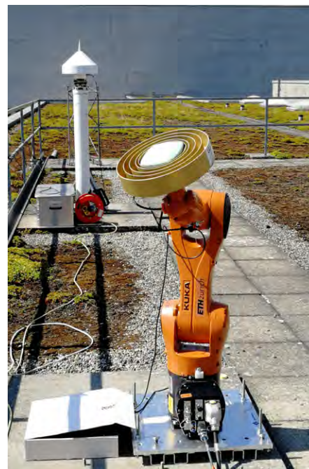
Abb. 3: KUKA 6-Achsen Industrieroboter auf dem Dach des Instituts für Geodäsie und Photogrammetrie der ETH Zürich auf dem Hönggerberg. Im Hintergrund ist die Referenzantenne zu sehen.
