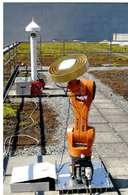
Fig. 3: Robot industriel KUKA à six axes sur le toit de l'Institut de géodésie et de photogrammétrie de l'ETH Zurich au Höggerberg. L'antenne de référence est visible à l'arrière-plan.
