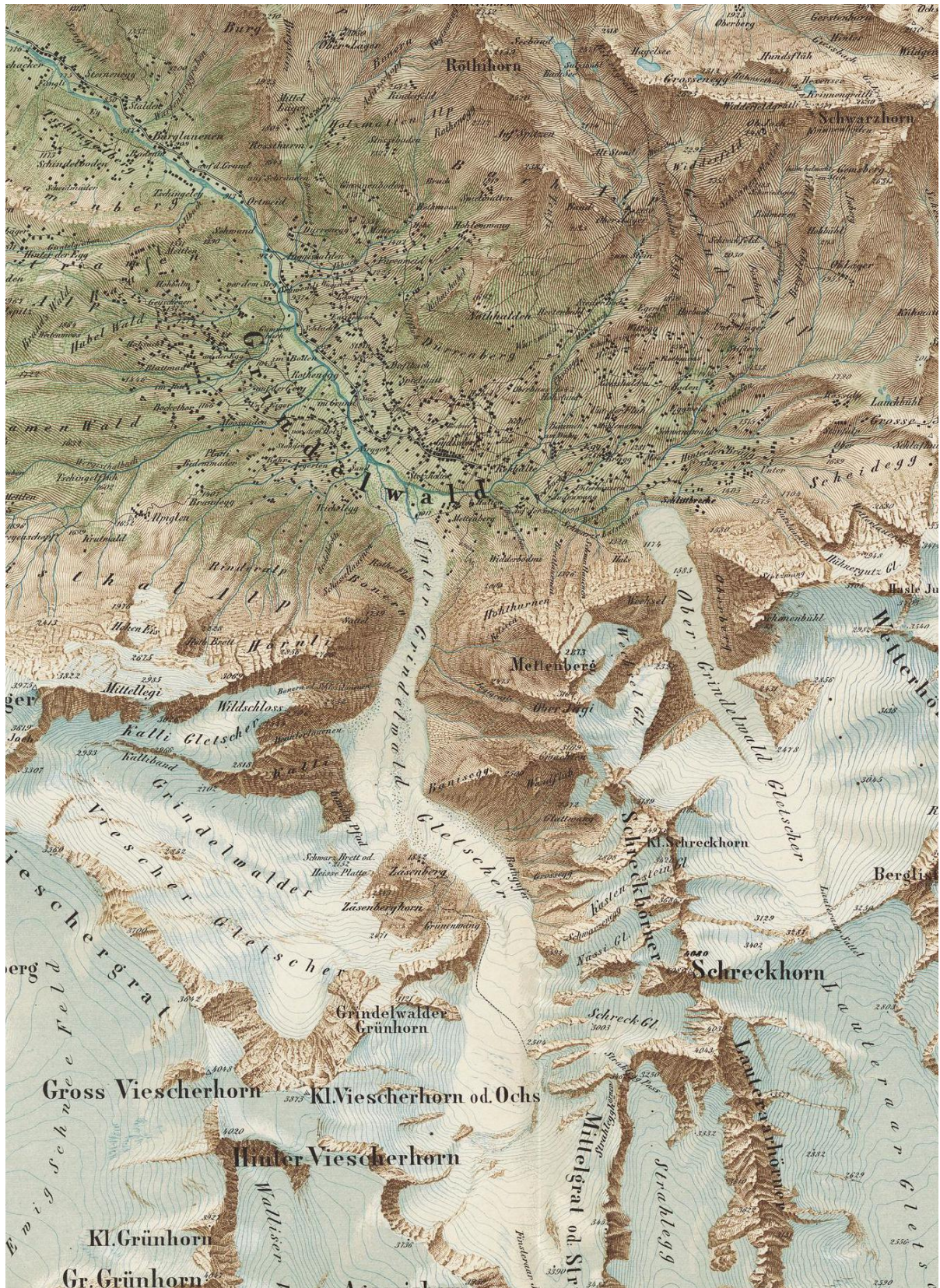
Detail (I) aus der von Rudolf Leuzinger 1865 in Stein gravierten «Karte des Hochgebirg's von Grindelwald». Die Topographie ist mit braunen Schattenschraffen und Felszeichnung, die Gletscher mit Höhenkurven und einer leichten Schattierung dargestellt. Der 3-D-Eindruck wird durch den künstlich erzeugten Lichteinfall von NW her suggeriert. Zudem zeigt ein grüner Waldton die vorhandene Vegetation auf. ((FH)) [e-rara]
