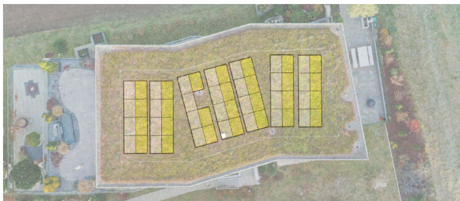
Abb. 4: Beispiel eines Dachplans aus «SketchUp Pro».
